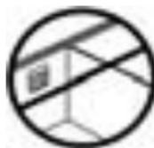
Не розташовуйте терморегулятор на внутрішній поверхні зовнішніх стін будівлі.
