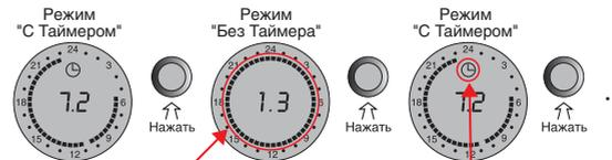
Для режима "С Таймером" – символ таймера ⌚ на дисплее. Признак режима "Без Таймера" – отсутствие этого символа и полностью "черная" окружность дисплея.
